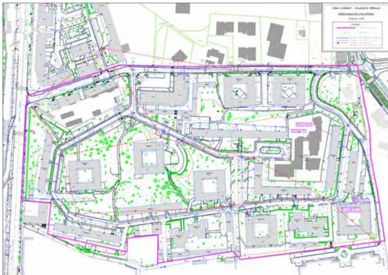
Zonage du réseau d'alimentation en eau potable actuel sur le secteur projet – EGIS 2019
