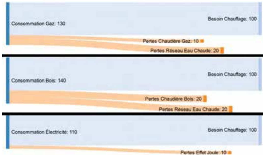
Schéma simplifié de la chaîne énergétique de plusieurs systèmes de chauffage
